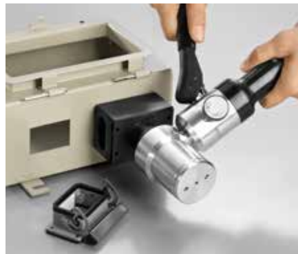
Автоматическое центрование в местах сверления при пробивке отверстий для промышленных разъемов.
